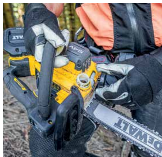
Könnyen hozzáférhető olajtartály a fűrészben.
