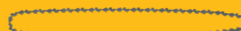
DT20693-QZ 20 CM-ES LÁNCFŰRÉSZLÁNC A DCMPS520 MODELLHEZ 8"-es láncvezető, 9,5 mm LP, 0,043"-es/(1,1 mm-es) méret, 34 láncszem, félsarkos, reszelő: 4 mm
